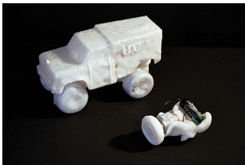
[3.3] FORMPLAST kan til enhver tid opvarmes og omformes – brug varmt vand, en hårtørrer eller lign.
