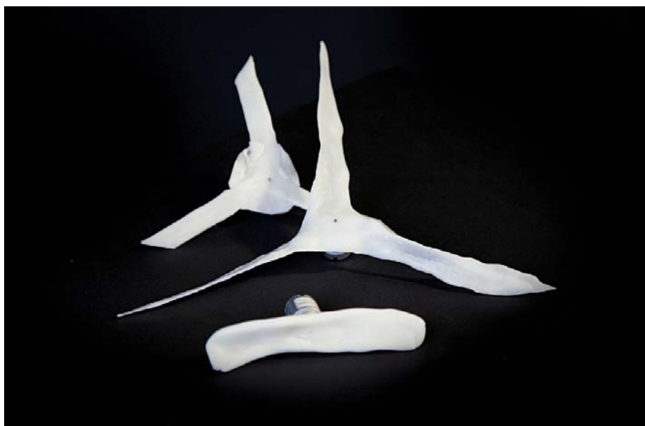
[4.3] Forsiden af vingerne skal hælde hver sin vej, så den ene vinge presses opad, mens den anden presses nedad.
